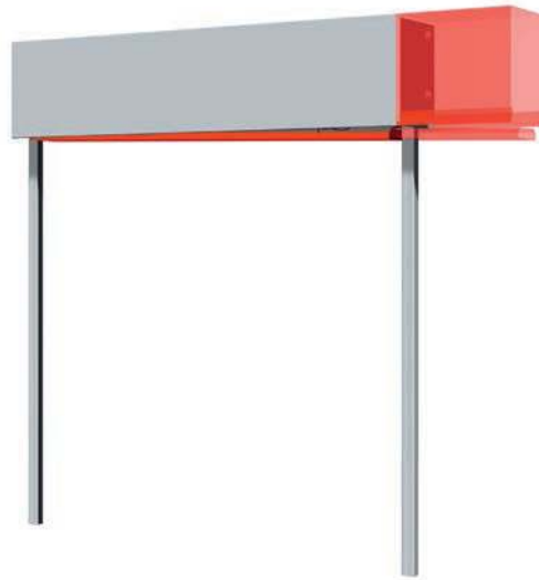
Bild 13: Veränderte Endlagenposition der Unterschiene (Unterschiene schief), Lamellenpaket einseitig sichtbar
